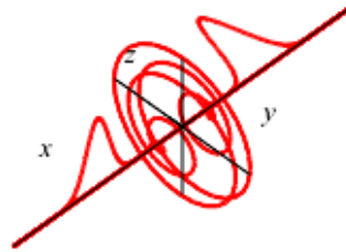
Abbildung 3.4: 'Gaußscher Korkenzieher': Das Gaußpaket startet mit einer reellen Amplitude. Im Nulldurchgang wird daraus ein Wellenpaket mit kürzester Wellenlänge. Am gegenüberliegenden Umkehrpunkt ist das Gaußpaket rein imaginär.
