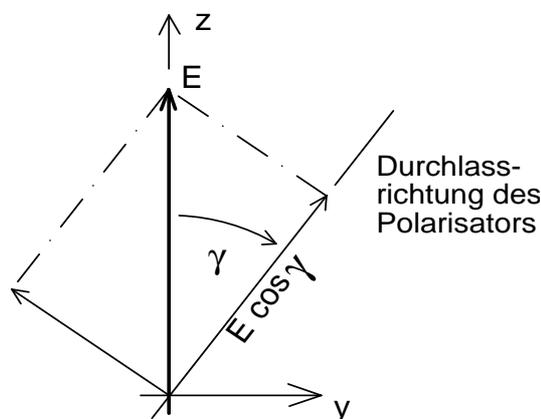
Die Formel (1) lässt sich mit Hilfe einer Fotozelle experimentell leicht überprüfen.
