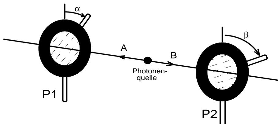
Die Orientierung der beiden Polarisatoren werden hier – bezüglich einer Vertikalen – durch die Winkel  $\alpha$  bzw.  $\beta$  angegeben. Die beiden Photonen erreichen nahezu gleichzeitig die Polarisatoren.
